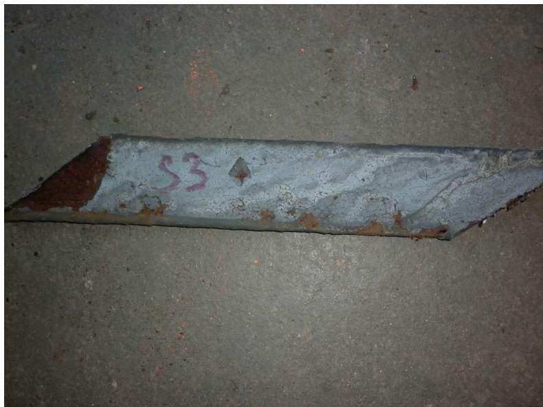
Obr. 3.4 – Vzorek S3 odebraný ze ztužení diagonály v poli 3.
