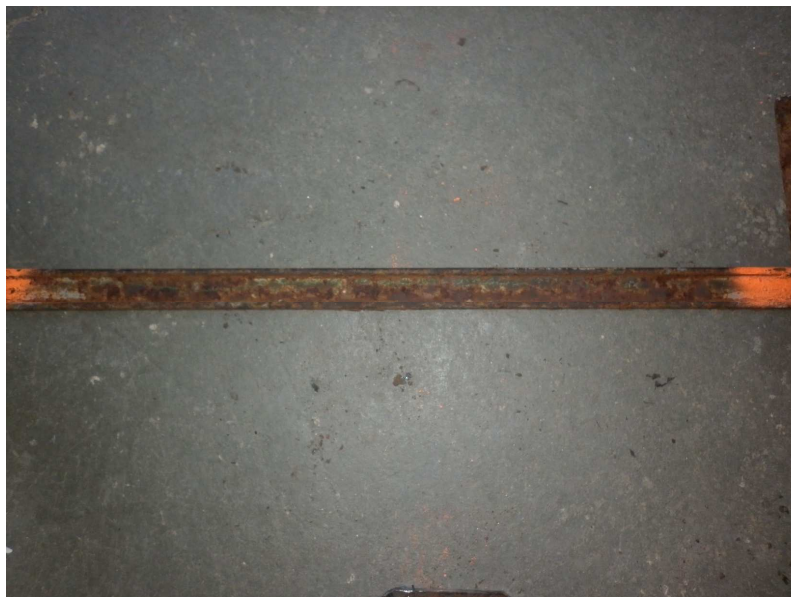
Obr. 3.3 – Vzorek S2 odebraný se spodního madla zábradlí v poli 5
