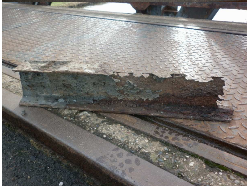
Obr. 3.5 – Vzorek S4 odebraný ze zcela korozi přerušného podélníku v prostoru pod chodníkem v poli 1.
