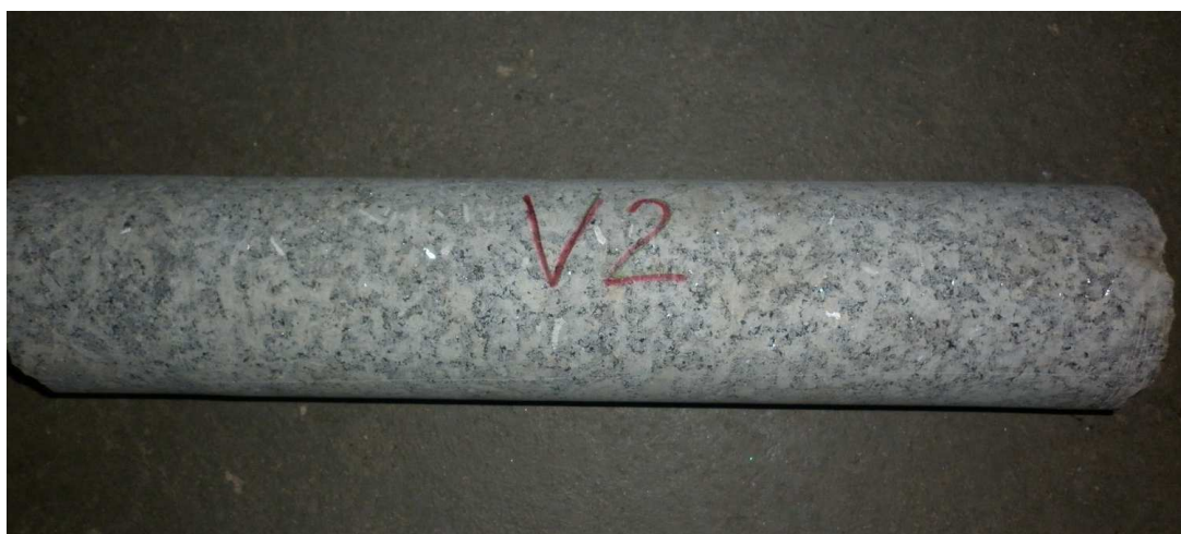
Obr. 3.1 – odebraný jádrový vývrt V2
